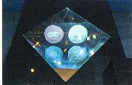
アスカネットは、装置のガラス板上の空中に映像が浮いて見えるデジタルサイネージを出展。真正面から映像にタッチする(空中を突っつく)と映像が反応し画面が切り替わる
